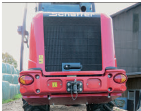
Als Zusatzgewicht ist eine 200 kg Platte unter dem Heck montiert. Die Beleuchtung ist recht gut geschützt untergebracht.
