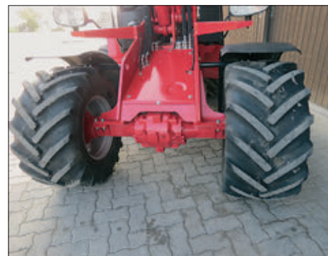
Original Schäffer Achsen mit 9.000 daN Nutzlast und eine gute Bereifung passen zum starken Antrieb.
