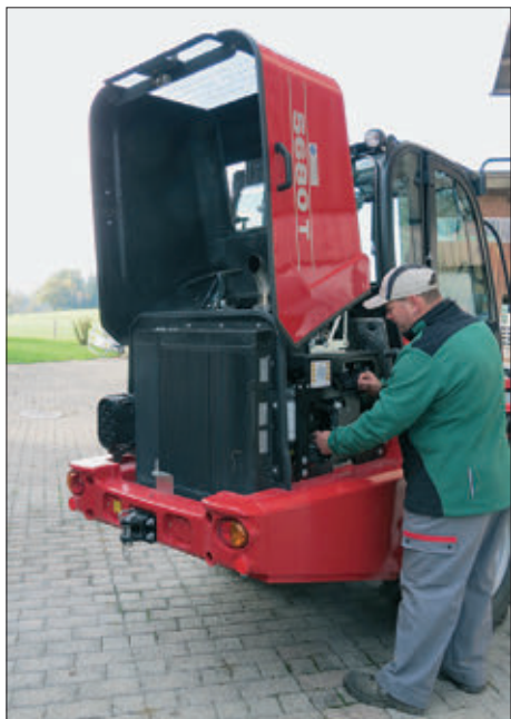
Eine vorbildliche weit öffnende Haube erleichtert die Wartungsarbeiten.
