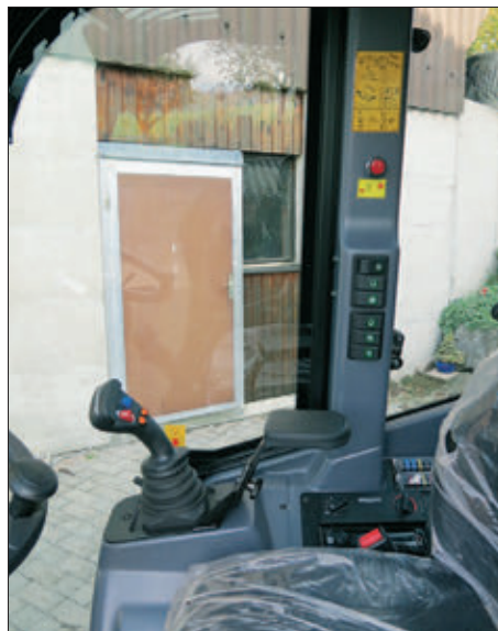
Sämtliche wichtigen Bedienelemente sind auf der rechten Kabinenseite angeordnet.
